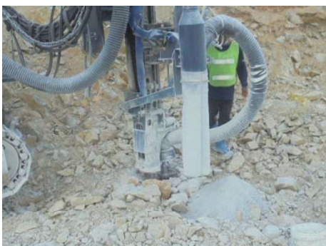
รูปที่ 2-13: รถเจาะรูระเบิดที่มีการติดตั้งแผ่นกรองฝุ่น
