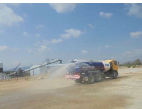
รูปที่ 2-22: รถบรรทุกน้ำฉีดพรมน้ำบริเวณโรงโม่หิน
