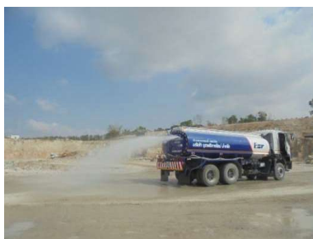
รูปที่ 2-20: รถบรรทุกน้ำฉีดพรมน้ำบริเวณพื้นที่ หน้าเหมือง
