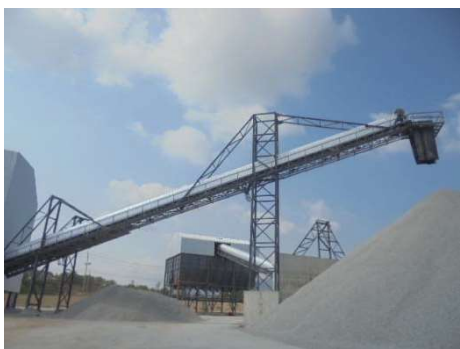
รูปที่ 2-17: การปิดคลุมระบบสายพานลำเลียง ที่เทกองหิน
